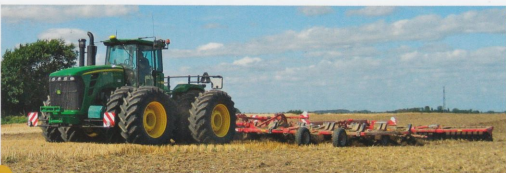
Bregentved och Turebyholm Landbrug har under hösten investerat i en ny midjestyrd John Deere 9630, som istället för standardmonteringen har utrustats med åtta Trelleborg TM900 High Power, dimension 710/75 R42.
