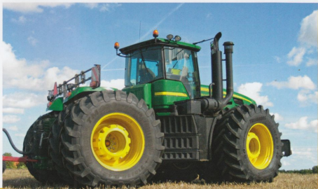
Vid stillastående ligger 55 procent av traktorns vikt på framhjulen och resterande 45 procent på bakaxeln. När traktorn drar den 12 meter breda harven överförs vikt till bakhjulen och belastningen på de båda axlarna blir då 50-50.
